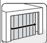
Das Tor läuft durch Rollen geführt in einer am Boden und einer an der Decke angebrachten Schiene entlang
